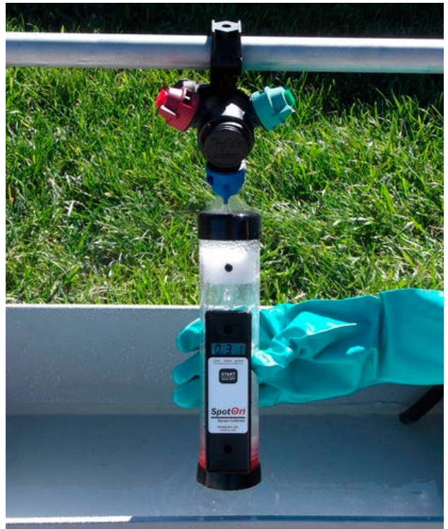
Фото 1. Електронний витратомір Spot On, який допомагає перевірити вилів з кожного розпилювача (л/с) і порівняти його з табличним.
