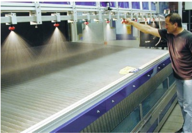
Фото 2. Паттернатор — плоский колектор, розміщений під кількома розпилювачами. Він дає можливість побачити рівномірність об'ємного розподілу, яку створюють увімкнуті розпилювачі на штанзі, яка не рухається.
