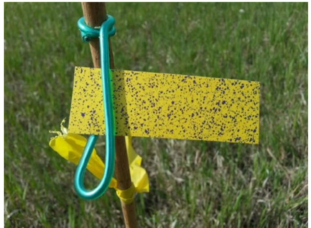
Фото 3. Водочутливий папір — найшвидший спосіб оцінити рівномірність розпилу під рухомою штангою, в ідеалі на цільовій поверхні, яку ми збираємося обробляти.
