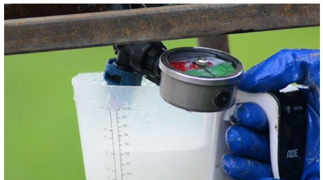
Тестер для вимірювання тиску на розпилювачі
